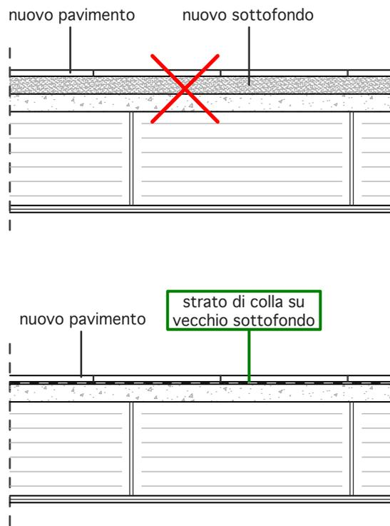
fig.9 - nessun uso di sottofondi per pavimenti
